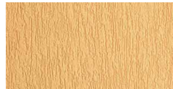
Tynk akrylowy o fakturze „kornikowej” Ceresit CT 64 , o uziarnieniu 2,0 mm, otrzymywany przez zacieranie pacą w jednym kierunku.
