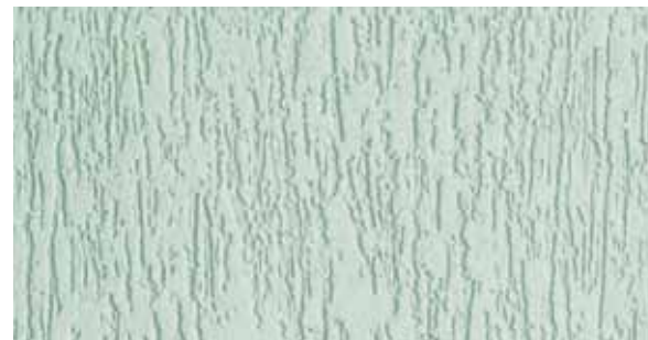
Tynk akrylowy o fakturze „kornikowej” Ceresit CT 63 , o uziarnieniu 3,0 mm, otrzymywany przez zacieranie pacą w jednym kierunku.
