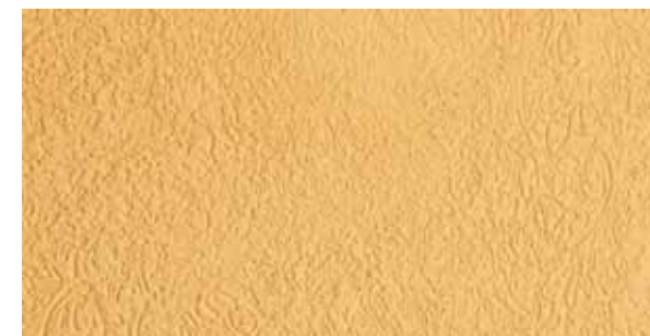
Tynk akrylowy o fakturze „kornikowej” Ceresit CT 64 , o uziarnieniu 2,0 mm, otrzymywany przez okrężne zacieranie pacą.
