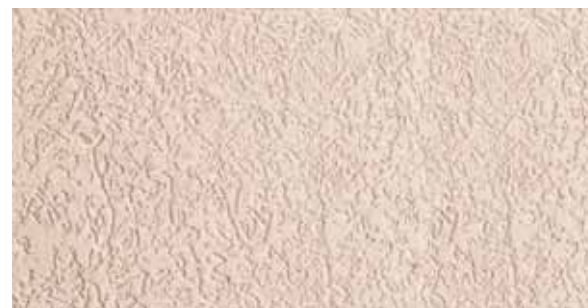
Tynk mineralny o fakturze „kornikowej” Ceresit CT 35 , o uziarnieniu 2,5 mm, otrzymywany przez okrężne zacieranie pacą.
